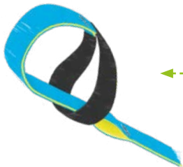
JOKER LIGHT mit Ankerstich = Bruchlast 2 475 daN
